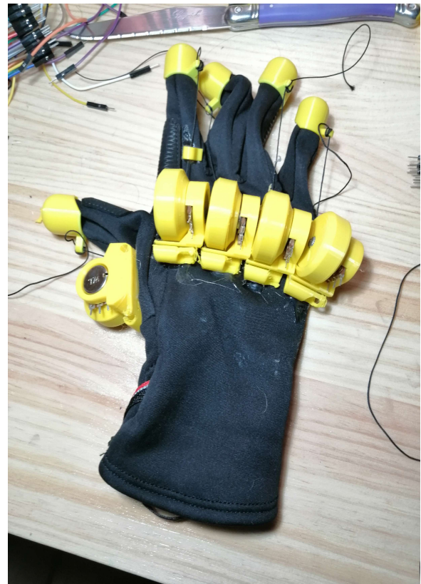
Imatge 64. Guant amb els potenciòmetres enganxats. Font pròpia.
