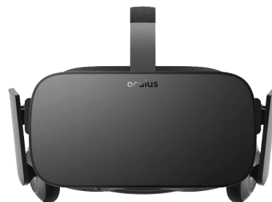
Imatge 23. Oculus Rift, per Oculus VR. Exemple de HMD binocular. Font: https://tworeality.com
