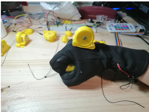
Imatge 62 i 63. Prova amb un potenciòmetre al guant. Font pròpia.
